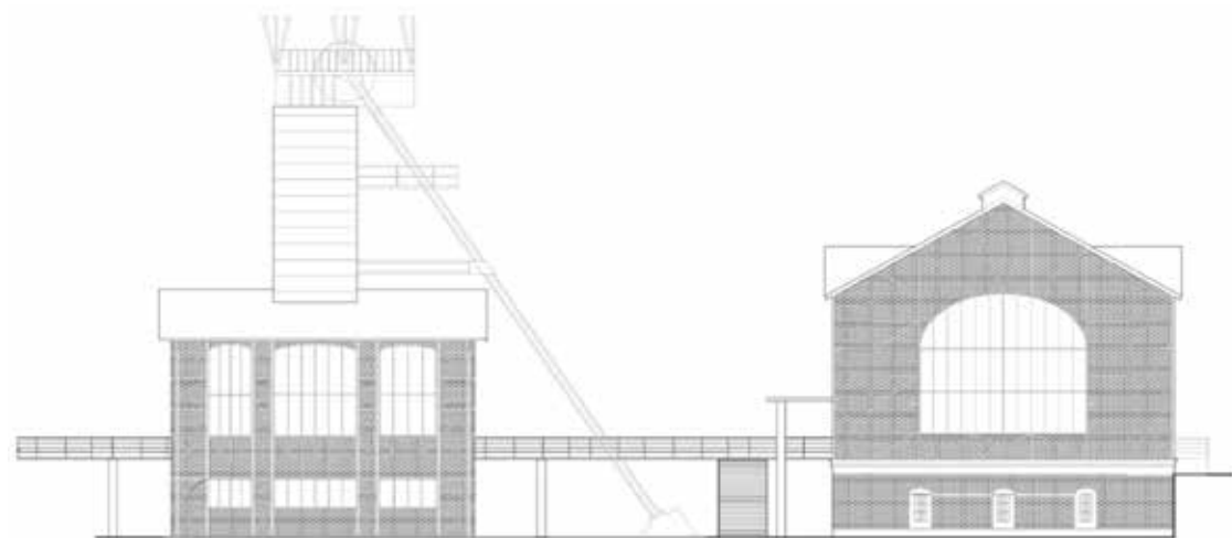
Pohled na objekt kompresorovny a těžní věž, oba objekty již po konverzi, lávka propojuje stávající objekty s objektem nové výrobní haly
