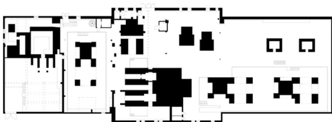
Suterén kompresorovny dolu Barbora s vyznačenými základy pro stroje
