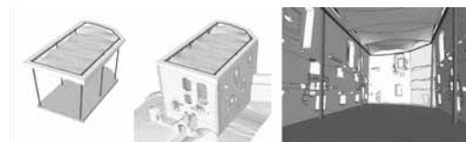
Obr. 5.: Zastrešenie pomocou vložených vertikálnych a horizontálnych konštrukcií, ktoré nesú ľahkú zhrňovaciu textilnú strechu (Zdroj: Archív autorov)
