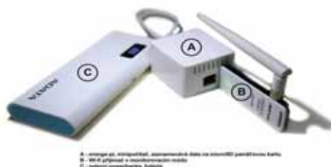
Obr.3.: Beta-verze prototypu data-loggeru (Zdroj: archiv autorů)
