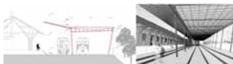
Obr. 9.: Zastrešenie pomocou rámových konštrukcií so zaveseným roštom a konzolovými nosníkmi (Zdroj: Archív autorov)
