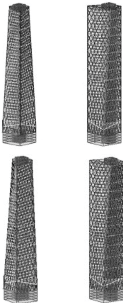
Obr. 2.: Modely exoskeletových konštrukcií: vľavo – s rohovými stĺpmi, vpravo – čisto diagridová konštrukcia (autori)
