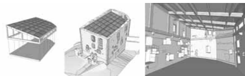
Obr. 3.: Zastrešenie pomocou dreveného trémového stropu v kombinácii so sklom, kde trámy sú uložené na vložených obvodových Vierendelových nosníkoch na pôvodných konzolách v obvodových stenách (Zdroj: Archív autorov)
