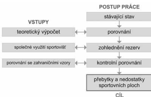
Obr. 4.: Postup návrhu generelu v ÚP (Zdroj: prezentace Kontexty navrhování sportovních staveb, Prof. Ing. arch. M. Kopřiva)
