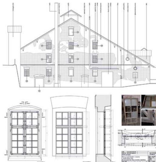
Obr.10.: JV fasáda objektu taviarne – súčasný stav. Zameranie výplne typického okenného otvoru štítových fasád. (Zdroj: Obnova fasád objektu Taviarne v areáli Dolnej huty. Projektová dokumentácia. S. Petrášová, 2015.)
