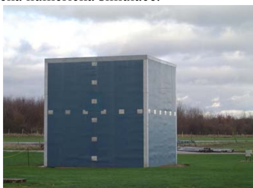
Obr. 1: Silsoe krychle s odběrovými místy (vlevo) a schéma rozložení tlakového zatížení na povrchu při numerické simulaci (vpravo)
