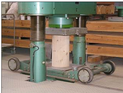
Obr. 2.1 Tlaková zkouška sloupu výšky 500 mm
