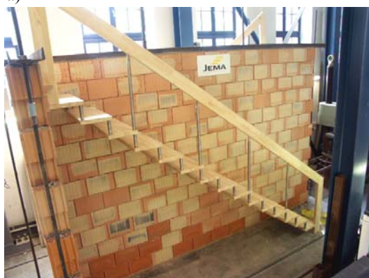
Obr. 3: Prototyp přímého dřevěného třmenového schodiště před (a) a v průběhu zatěžovací zkoušky (b)
