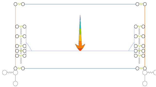
Obr. 1: Geometrie modelované konstrukce spolu se zatížením a podporami
