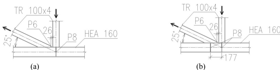
Obr. 2. Geometrie N styčnicku pásu z HEA profilu a RHS mezipásových prutů (a) První návrhová situace; (b) Druhá návrhová situace.
