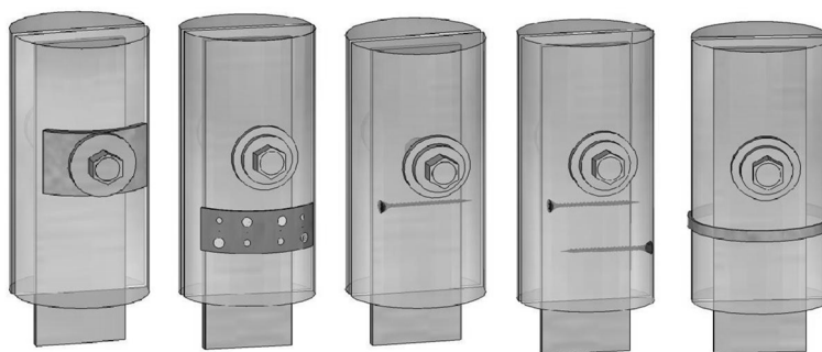
Obr. 1: Způsoby zesílení dřevěného prvku: speciální podložka, perforovaný plech, jeden vrut/samovrtný vrut, dva vruty, pásek (zleva)
