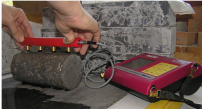
Obr. 1: Použití měřicí sondy na betonovém válci a samotný měřicí přístroj zobrazující elektrický odpor
