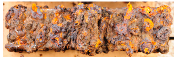
Obr. 1: Korozní produkty vzorku skupiny 4 se svari
