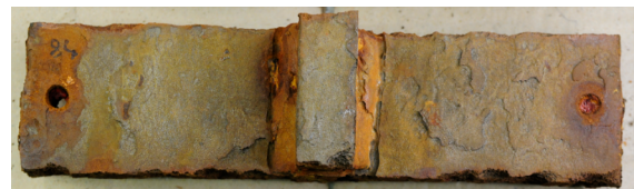
Obr. 2: Odmořený povrch vzorku skupiny 4 se svari
