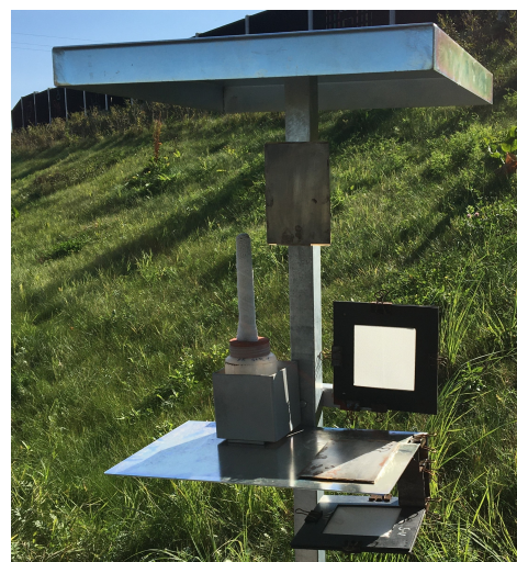
Obr. 1: Zkušební stojan experimentálního měření in situ - vlevo metoda mokré svíce, vpravo metoda vertikální suché desky, dole metoda horizontální suché desky
