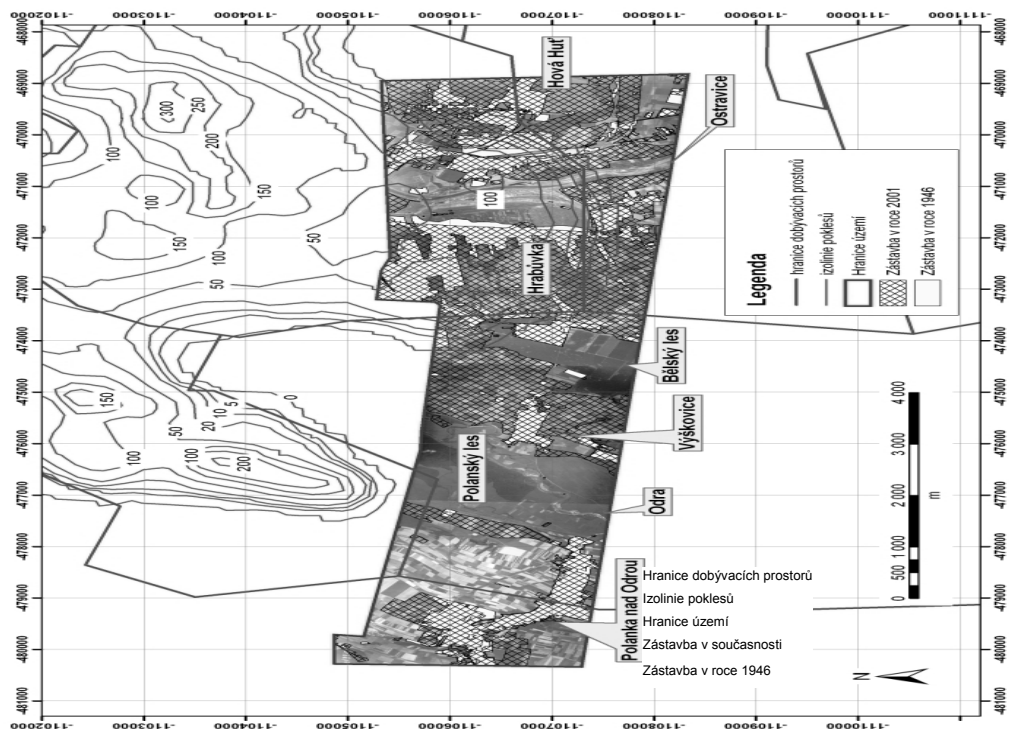
Obr.12 Izolinie poklesů v letech 1961-1989 a dobývací prostory zobrazené na leteckých snímcích z roku 1946
