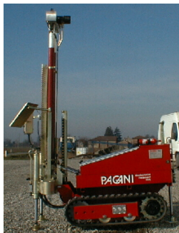
Obr.2.1 Penetrometr Pagami T6 63 pro realizaci statické i dynamické penetrace (vpravo - použitý typ hrotu a rotační hlavy)
