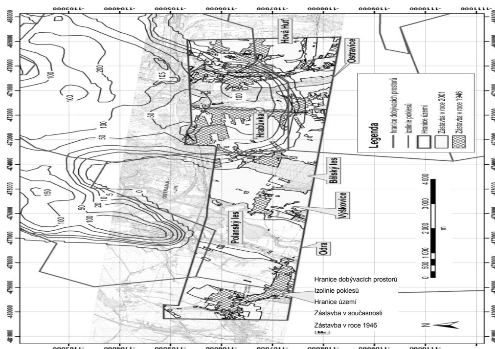
Obr.15 Izolinie poklesů v letech 1961-1999 a dobývací prostory zobrazené na současných topografických mapách
