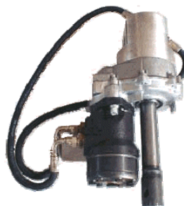
Obr.2.1 Penetrometr Pagami T6 63 pro realizaci statické i dynamické penetrace (vpravo - použitý typ hrotu a rotační hlavy)
