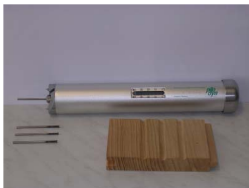
Obr.7 Měření hustoty - Pilodyn
