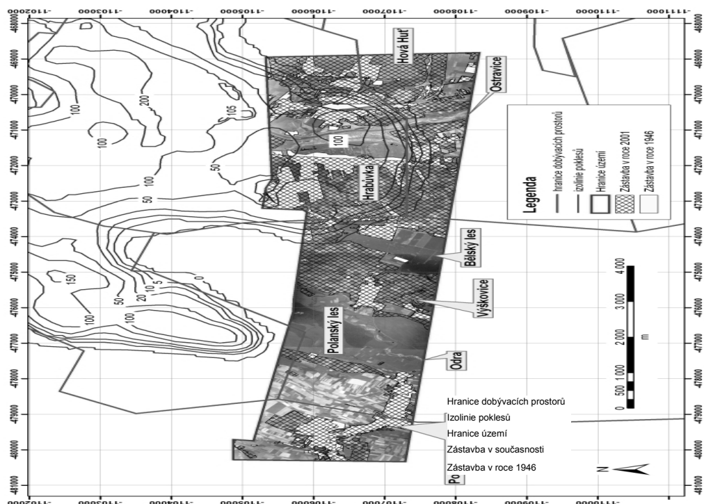
Obr.14 Izolinie poklesů v letech 1961-1999 a dobývací prostory zobrazené na leteckých snímcích z roku 1946
