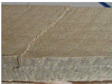
Obr. 5: Porušení bukového řeziva v tlakové oblasti
