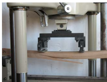
Obr. 6: Porušení dubového řeziva v tahové oblasti
