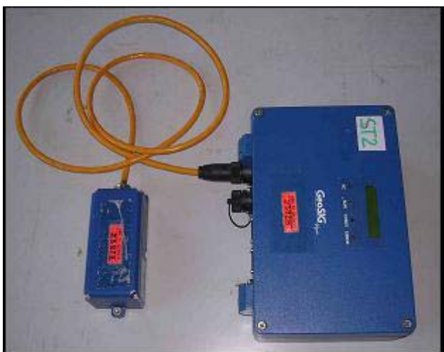
Obr. 1: Seizmická aparatura GCR-16 (GeoSIG) se senzorem.
