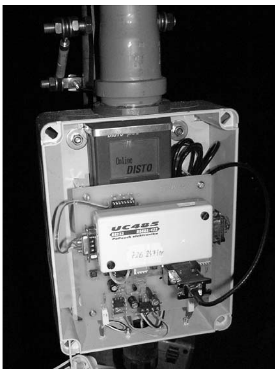
Obr. 3 Interface pro Disto TM A4 s přenosem dat přes rozhraní RS232.
