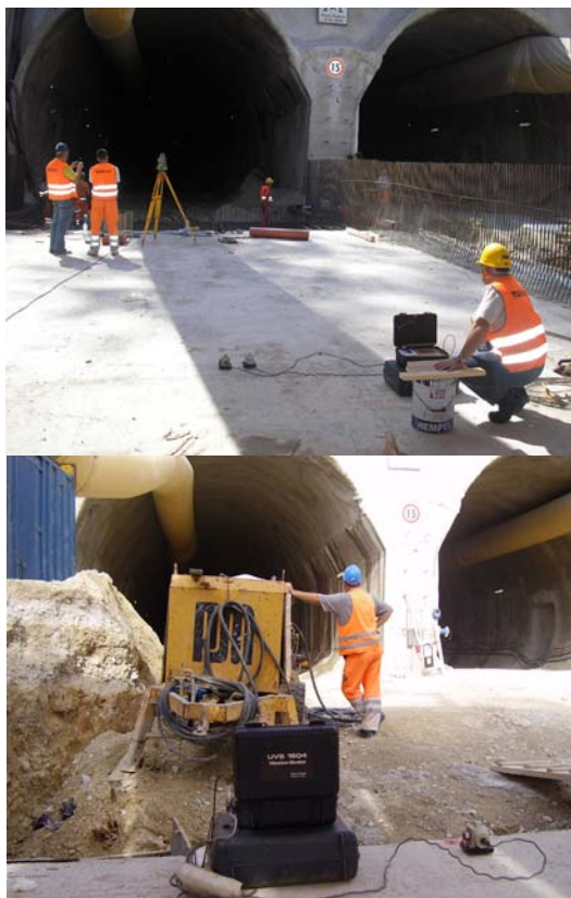
Obr. 4 Meracie stanovisko 1 – základová doska č.100P – pravá tunelová rúra hlbená časť - Seizmograf UVS 1504
