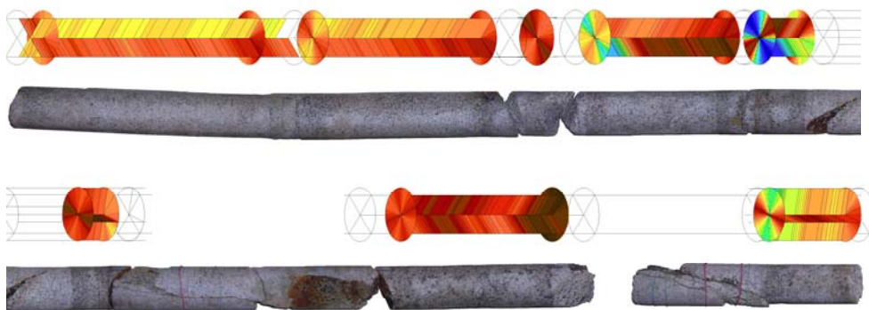
Obr. 8 Grafické znázornění průběhových rychlostí ultrazvukových vln podél vrtného jádra (vrt 1). Barevná škála zobrazuje rozsahy průběhových rychlostí ultrazvukových vln v m/s – viz. obr. 6.
