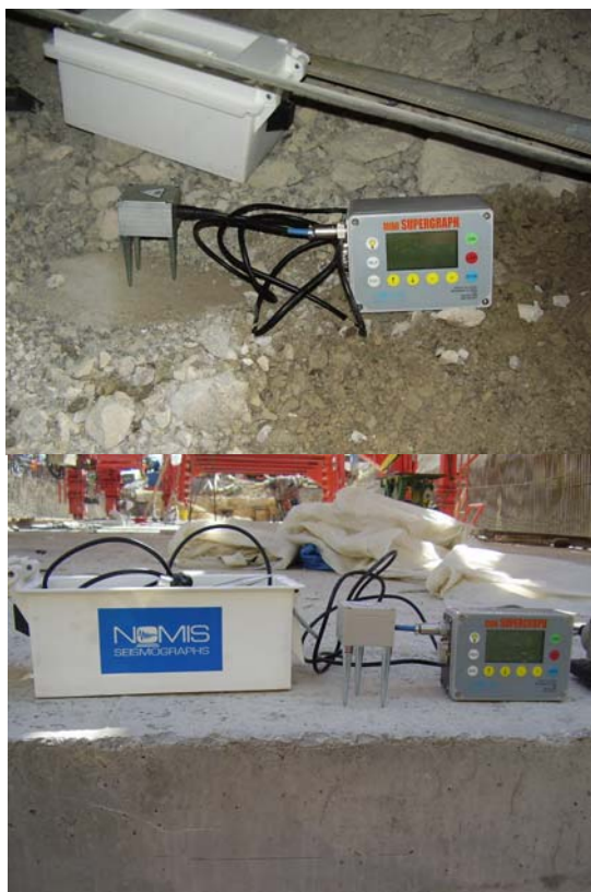
Obr. 5 Meracie stanovisko 2 – pravá tunelová rúra ochranný stredový pilier - Seizmograf NOMIS mini SUPERGRAPH
