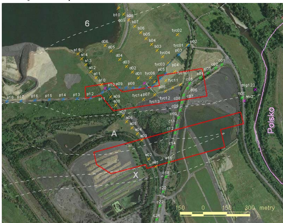
Obr. 1 Poruby 361 000 a 293 102, tektonické poruchy a body pozorovací stanice
