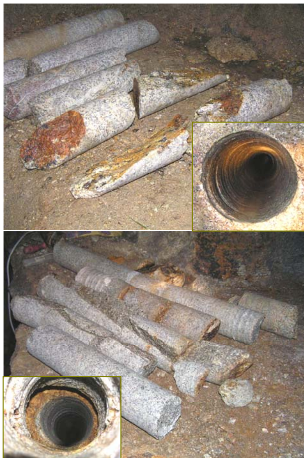
Obr. 1 Vrtná jádra a pohled do vrtu – vlevo vrt 1, vpravo vrt 2
