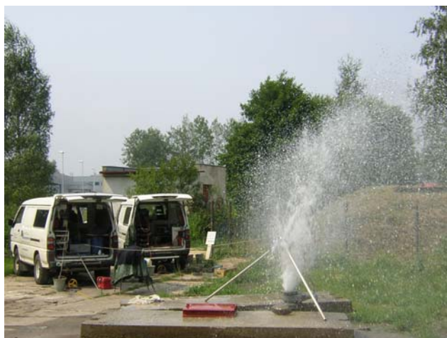
Obr.1 Karotážní měření a TV prohlídka v novém vrtu s přetokem
