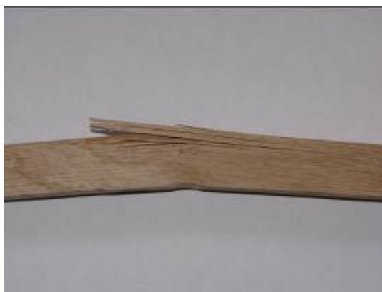
Obr. 8: Částečné porušení vzorků listnatého řeziva
