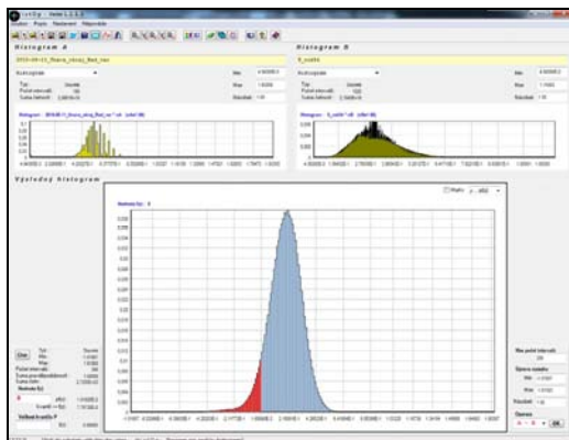
Obr. 5: Histogram funkce spolehlivosti G_{fail} po 54 letech provozu mostu – šíření z okraje
