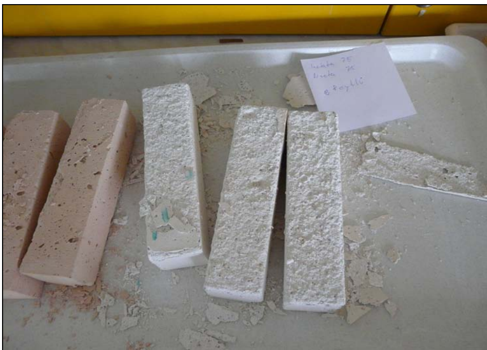
Obr. 6: Šupinovité odpadávání povrchových vrstev při zkoušce mrazuvzdornosti
