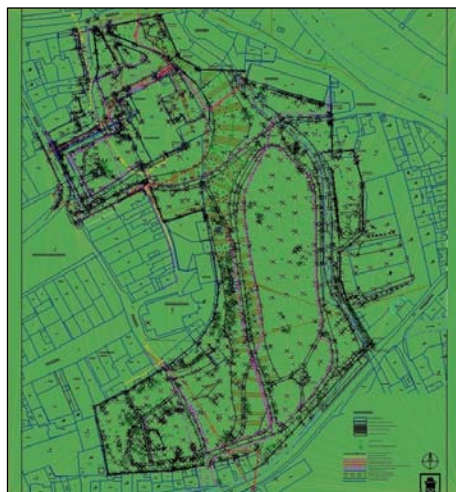
Obr. 5: Katastrální mapa s výškovými kótami jako podklad pro modelaci terénu
