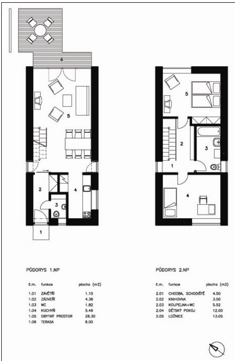
Obr. 5: Půdorysné řešení příkladové realizace
