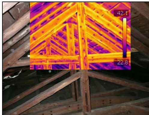
Obr.19: Termosnímek hřebene bedněného klenutí kostela kolem 21:00 s viditelným pásem izolace z ovčí vlny, položeném v interiéru krovu na jejím prohřátém vrcholu. Nejprohřátější místa bednění mají teplotu až 43,4 °C, naopak vrchol klenby zaizolovaný vlnou pouze 29,9 °C, což představuje rozdíl v teplotě o takřka 13,5 °C.
