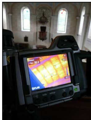
Obr.17: Detail termokamery při sledování teploty klenby
