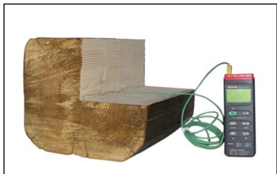
Obr. 3: Měření pomocí elektrického teploměru, ukázka v řezu
