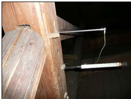
Obr.15: Ukázka umístění elektronického termočlánku a klasického kapalinového teploměru
