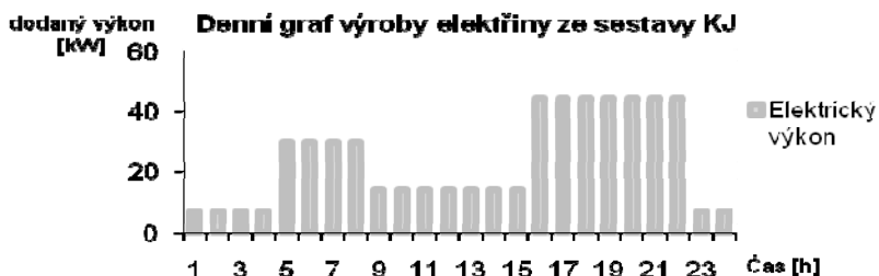
Obr. 6: Elektrický výkon jednotek v průběhu dne při pokrytí potřeby tepla
