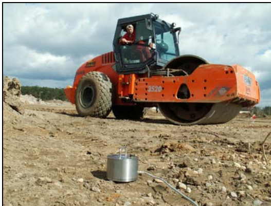
Obr. 1: Měření dynamické odezvy vibračního válce
