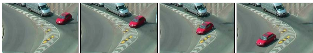
Obr. 13: Zneužití chybně instalovaných příčných prahů
