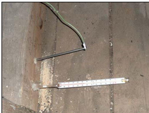
Obr.15: Ukázka umístění elektronického termočlánku a klasického kapalinového teploměru
