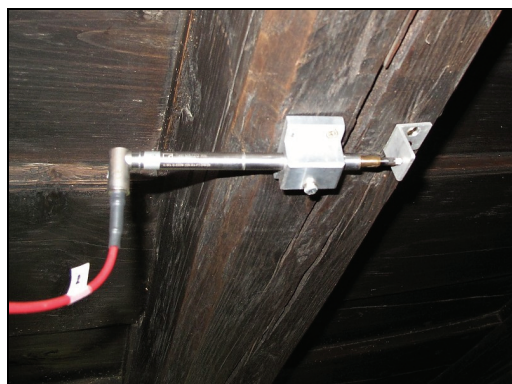
Obr. 6: Termočidlo zabudované do napadených dřevěných konstrukcí. V ústí měřidel do dřeva je nainstalována tepelná izolace pro zamezení ovlivnění výsledků měření horkým vzduchem vnějšího prostředí. Tenzometr (vlevo) byl instalován do staršího stropního trámu se stávající starší trhlinou.
