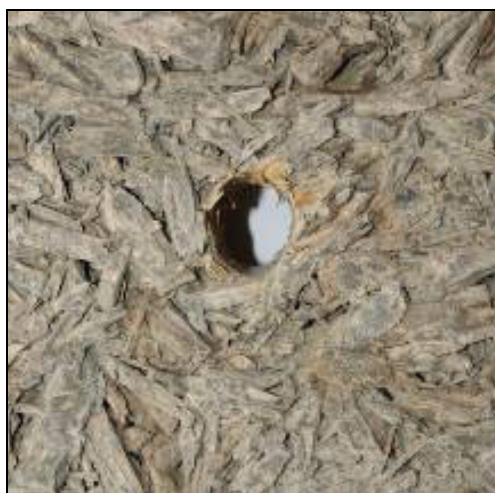
Obr. 8: Deformace otvoru po destruktivním testování pro průměr kolíku 12 mm
