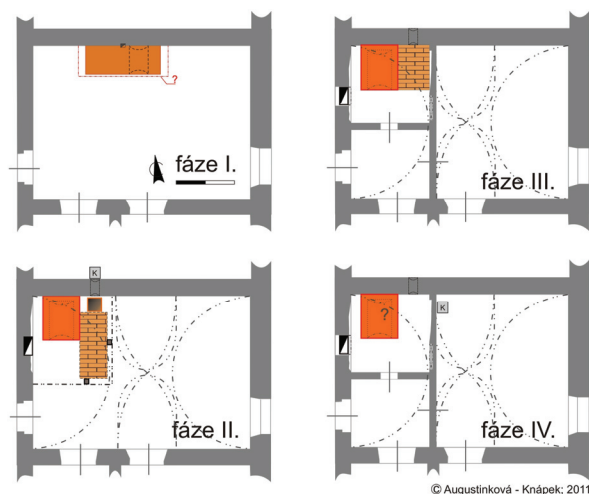
Obr. 4: A. Knápek, rozkreslení 4 hlavních vývojových fází kuchyně v m. č. 127 na zámku v Rychvaldě, 2011
