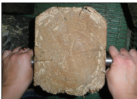
Obr. 3 a obr. 4: Kalibrace přístroje a laboratorní měření s přístrojem PUNDIT
