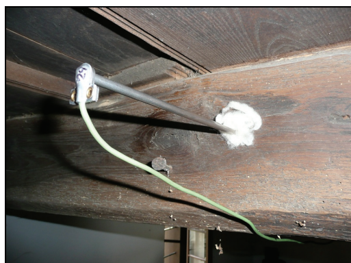
Obr. 6: Termočidlo zabudované do napadených dřevěných konstrukcí. V ústí měřidel do dřeva je nainstalována tepelná izolace pro zamezení ovlivnění výsledků měření horkým vzduchem vnějšího prostředí. Tenzometr (vlevo) byl instalován do staršího stropního trámu se stávající starší trhlinou.
