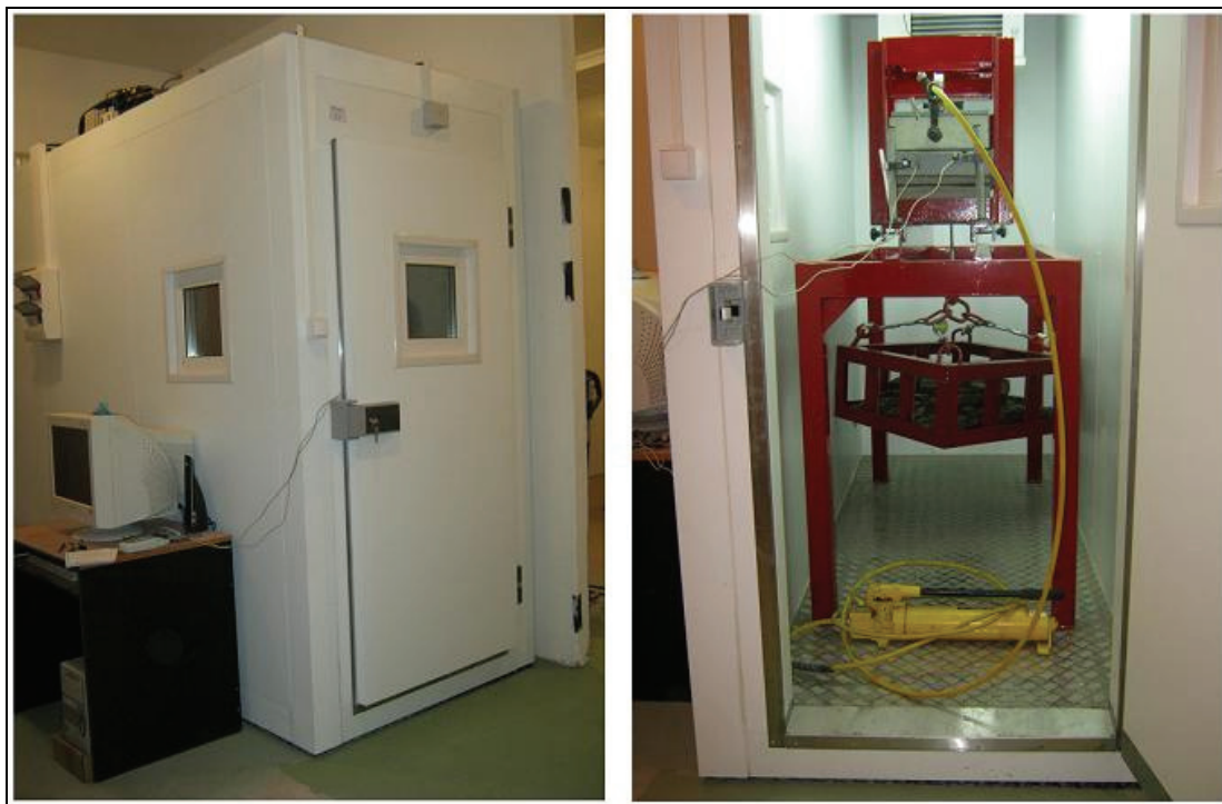
Obr. 2: Zkušební zařízení umístěné v klimatizační komoře
