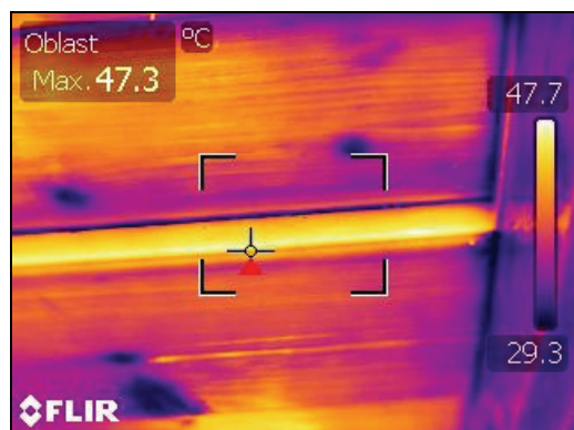
Obr. 8: Využití termokamery při sledování teplotních změn při procesu termosanace – pohled na deskový záklop
