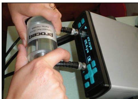
Obr. 3 a obr. 4: Kalibrace přístroje a laboratorní měření s přístrojem PUNDIT
