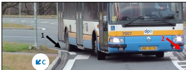
Obr. 9: Najetí autobusu do těsné blízkosti obrubníku nároží (číslo 1; konfliktní situace 2j_o1-O1K ); 2 ... najetí levým obrysem vozidla nad vodící proužek
