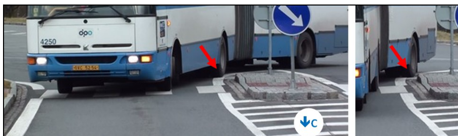
Obr. 8: Najetí autobusu na dopravní stín (konfliktní situace 2j_{so}1-O1K ), resp. do těsné blízkosti obrubníku ochranného ostrůvku (konfliktní situace 2j_o1-O1K ); levá fotografie ukazuje najetí na vodící čáru levým kolem druhé nápravy, pravá fotografie pak třetí nápravy stejného autobusu
