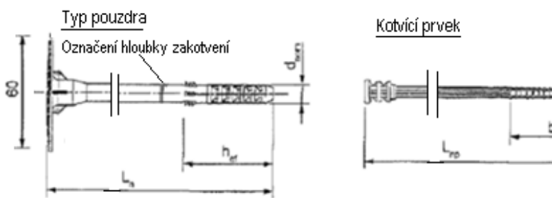
Obr. 5: Použité hmoždinky WKRET-MET-LTXØ10mm
