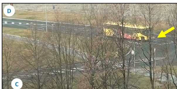
Obr. 7: Najetí autobusu do odbočovacího pruhu pro odbočování vlevo při odbočování vpravo (konfliktní situace 2j_r1-O1K )
