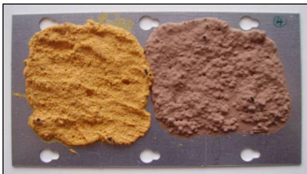
Obr. 5: Vzorek: pozinkovaná ocelová deska s omítkovinou
