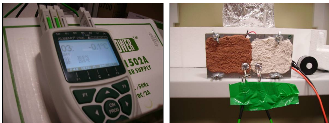
Obr. 3: Multifunkční přístroj Ahlborn® 2590-3S a dotyková NiCr čidla umístěná na vzorku
