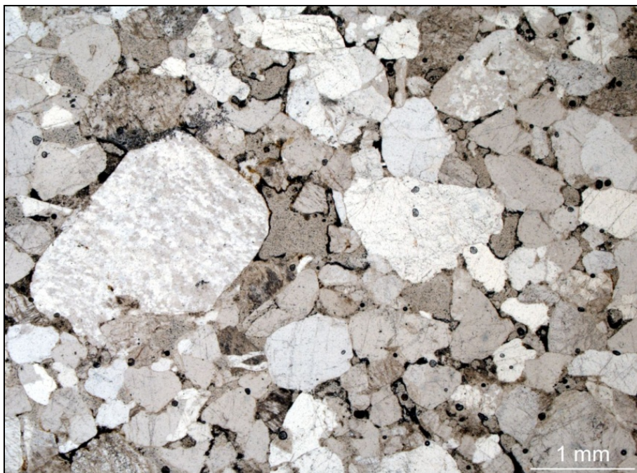
Obr. 1: Mikroskopická stavba pískovce z lokality Božanov (optická mikroskopie horninového výbrusu, procházející světlo)
