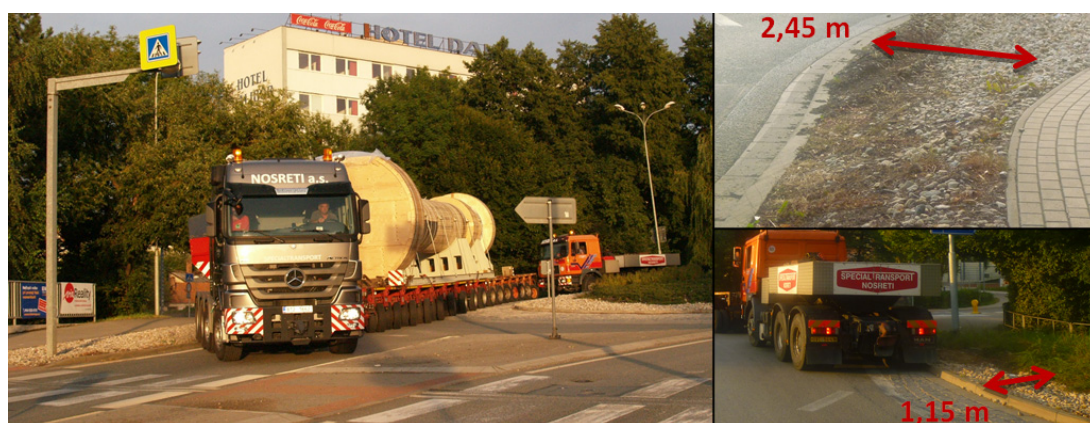
Obr. 4: Problematický průjezd okružní křižovatkou v Litomyšli (Foto: Ing. Petrů, Ing. Zeman)
