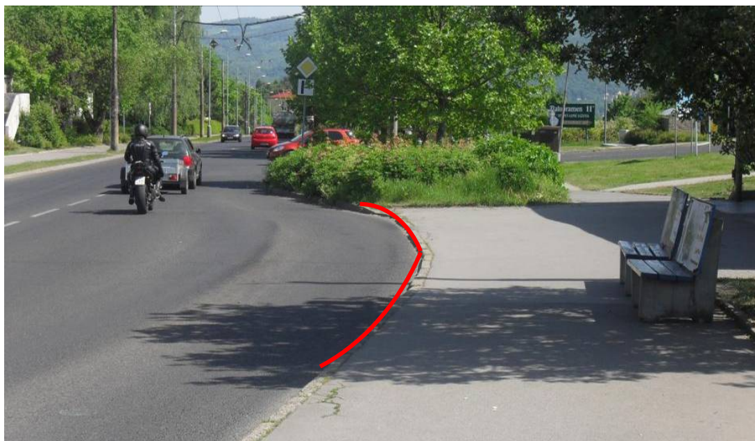
Obr. 6: Zaoblená nástupní hrana v zastávkovém zářivu
