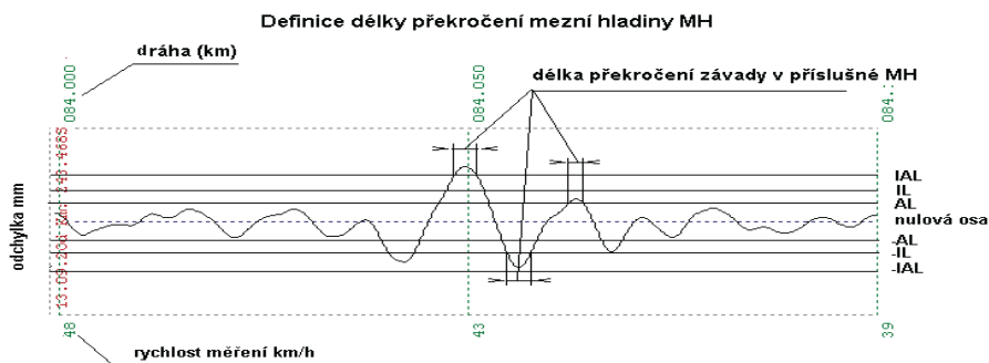
Obr. 2: Definice délky překročení mezní hladiny stupně AL, IL a IAL [5]
