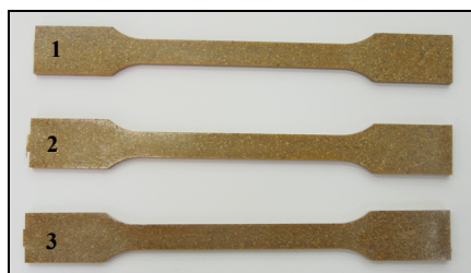
Obr. 1: Zkušební tělesa předepsaných rozměrů dle ČSN EN ISO 527, typ 1B, složení 1 (27%-ní podíl regranulátu v matrici), 2 (50%-ní podíl regranulátu v matrici) a 3 (100% matrice tvoří regranulát)
