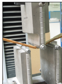
Obr. 3: Stanovení mezní síly při porušení tříbodovým ohybem
