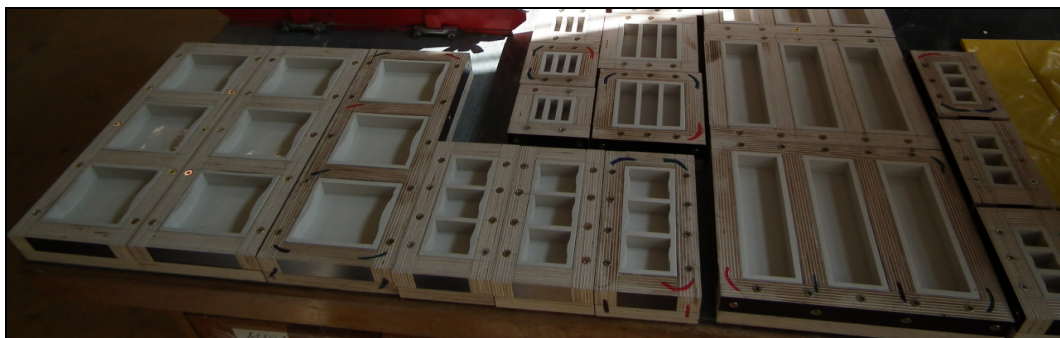
Obr. 10: Formy určené pro výrobu modCT těles (doplněné o formy pro trámečky zkoušené ve tříbodovém ohybu) (foto © Keršner 2013)
