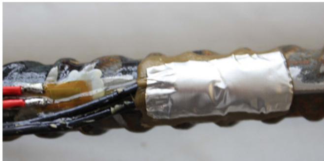
Obr. 6: Tenzometrický snímač s ochrannými prvky
