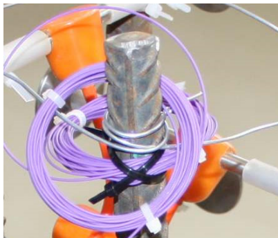
Obr. 4: Optické vlákno – kontaktní místo
